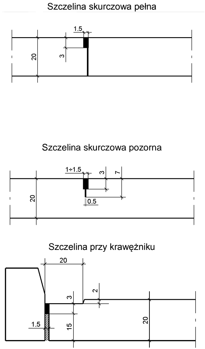
Rys. 1.1. Przykłady konstrukcji szczelin w podbudowie z betonu cementowego (wymiary w cm)
